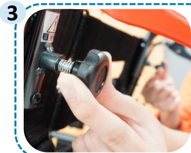
3 扭鬆手掣下方的兩個旋鈕，卸下頭靠板
