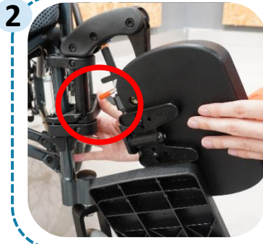
2 按住腳踏摺疊鎖向外撥，再提起以拆卸腳部承托
